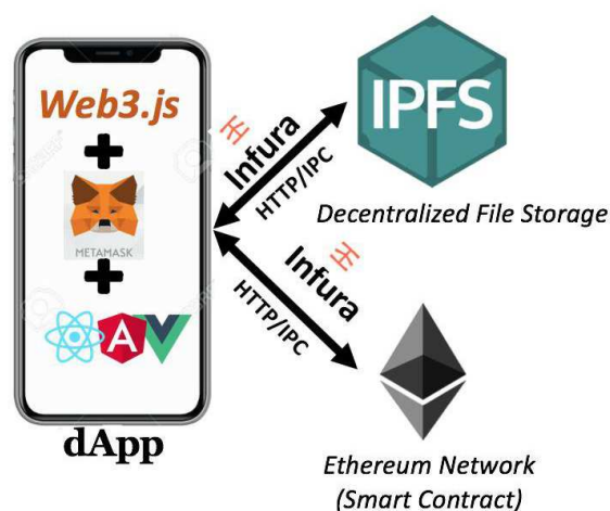
Náčrt architektúry Ethereum Dapp bežiacej na infraštruktúre spoločnosti Infura
